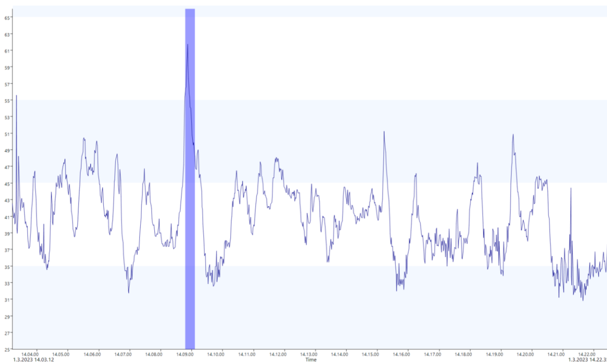
Kuva 4. Kuvaote mittausdiagrammista tulosten analysointivaiheesta. Selkeimmän melutapahtuman hetkellä noin klo 14:08:40 ajoi kaksi traktoria peräkkäin Pyhäntiellä, joista muodostui aistinvaraisestikin arvioiden poikkeavan kova liikennemelu. Muutoin tämän uusintamittauksen aikana raskasta liikennettä ohijoi Pyhäntiellä 1kpl kuorma-auto sekä 2kpl linja-autoja
