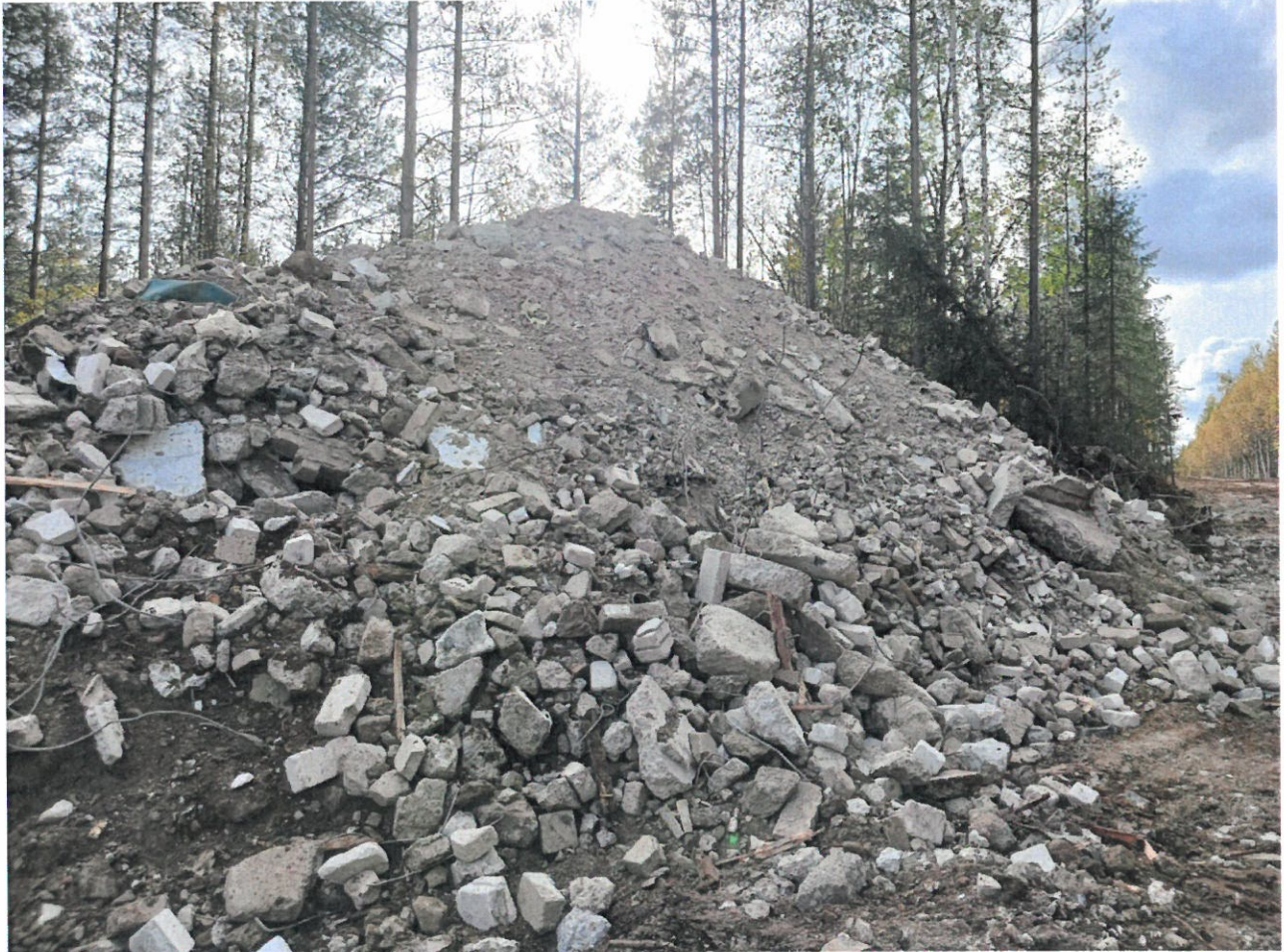
Kuva 4. Alueelle tuodun betonin seassa oli metallia ja muuta purkujätettä.
